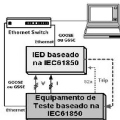
Figura 16: Teste funcional de IED
